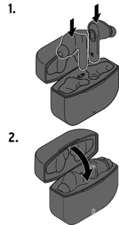
Die Ohrhörer schalten sich automatisch aus und werden wieder aufgeladen.
